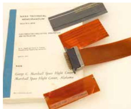
Technisches NASA-Memorandum über Flachkabel und Stecker von Wilhelm Angele, dabei einige Muster..
