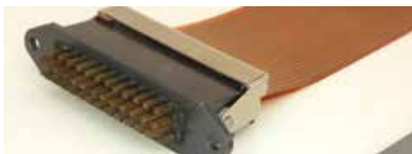
Solche Flachkabel und Stecker entwickelte Wilhelm Angele für die Weltraumtechnik.
